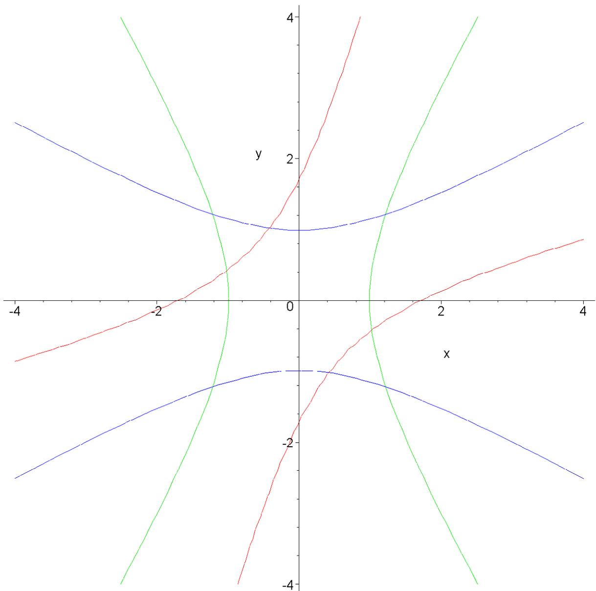
Die Hyperbel mit den "waagerechten" Ästen entstand durch Drehung um  $\pi/4$  (Vierteldrehung gegen den Uhrzeigersinn), während die Hyperbel mit den "senkrechten" Ästen durch Drehung um  $-\pi/4$  (Vierteldrehung im Uhrzeigersinn) entstand.
