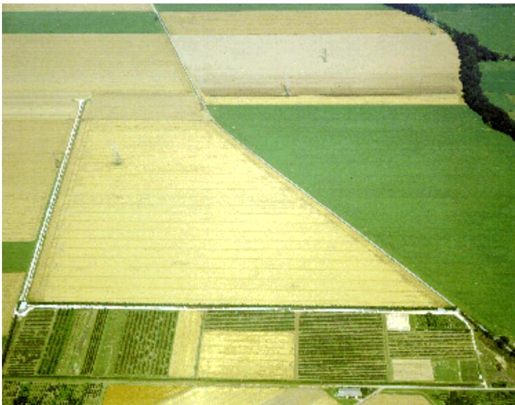
Die Anlage GEO600 bei Hannover. Jede der beiden rechtwinklig angeordneten Lichtlaufstrecken hat eine Länge von 300 m. Sie ist so empfindlich, dass man sogar besondere Vorkehrungen treffen musste, damit nicht die Wellen der Nordsee in über 200 km Entfernung zu Fehlmessungen führen.
