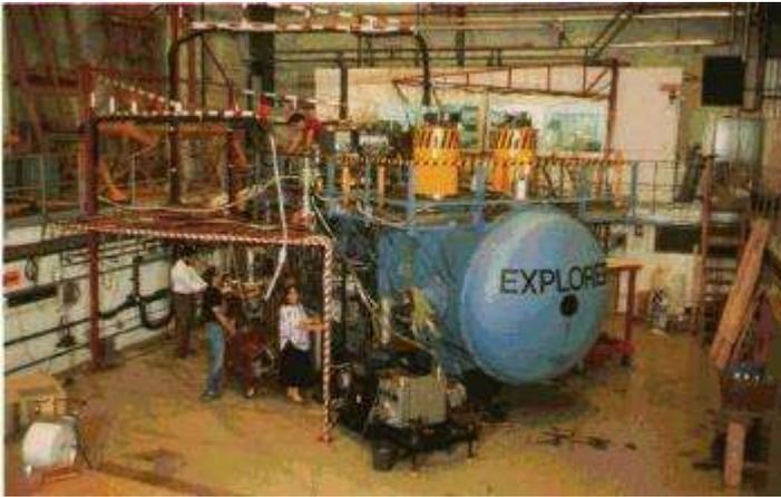
Eine andere Methode zum Nachweis von Gravitationswellen ist die Veränderung der Länge von starren Körpern. Wie hier beim **Explorer**-Experiment am **CERN** benutzt man dazu Zylinder aus einer speziellen Aluminiumlegierung. Der Zylinder ist 3 m lang, hat einen Durchmesser von 60 cm und wiegt 2,3 Tonnen. Zum Betrieb wird er durch flüssiges Helium auf eine Temperatur von nur 2 K (-271° C) abgekühlt. Seine Resonanzfrequenz liegt zwischen 903
